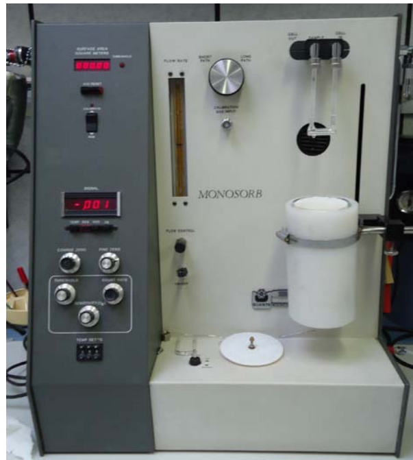
Figura 3.10. Equipo de adsorción-desorción de N 2 Monosorb Surface Area, modelo MS-13.
