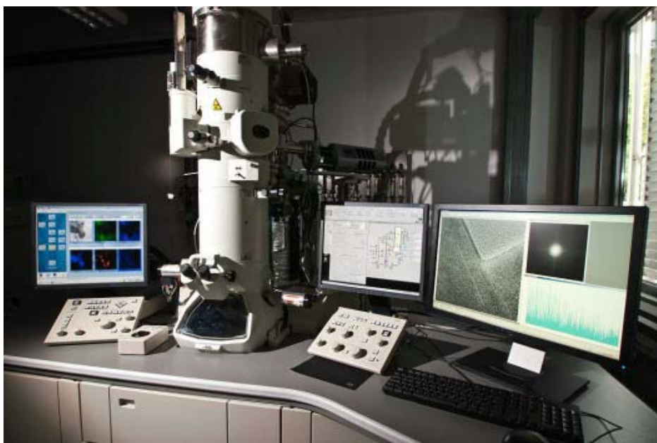
Figura 3.12. Microscopio electrónico de alta resolución JEOL JEM-2011 (Instituto de Catálisis y Petroleoquímica, ICP-CSIC).
