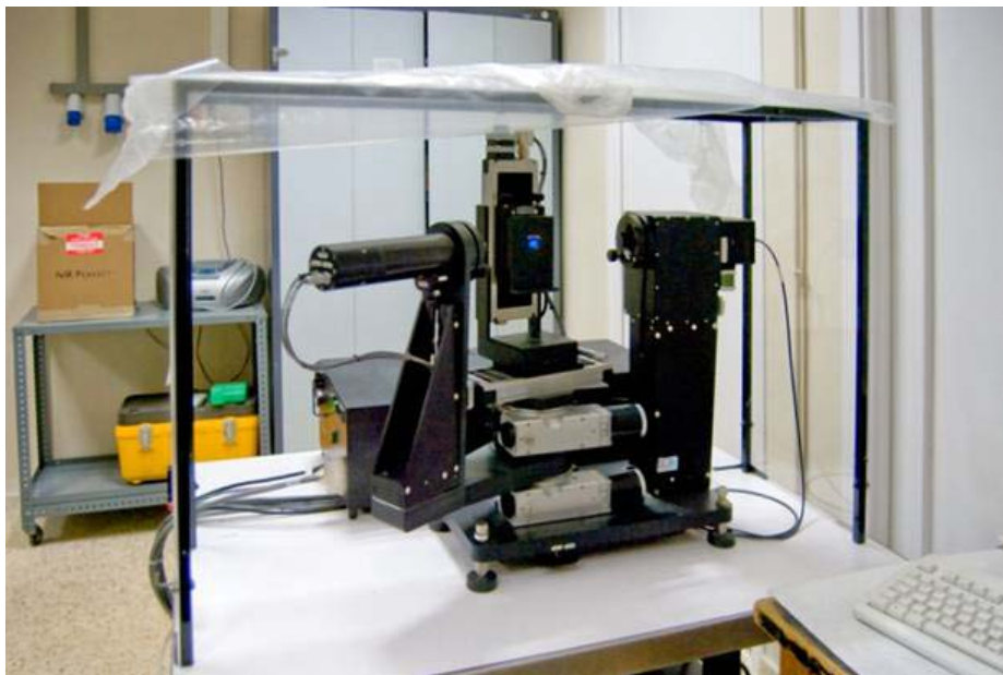
Figura 3.16. Elipsómetro espectroscópico VASE (IO-CSIC).
