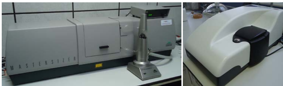
Figura 3.3. Equipo de difracción láser Mastersizer S (izquierda) y de dispersión dinámica de la luz Zetasizer Nano ZS (derecha).
