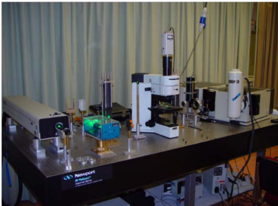
Figura 3.14. Sistema experimental de micro-Raman y fotoluminiscencia en el visible (Instituto de Ciencia de Materiales de Madrid, ICMM-CSIC).
