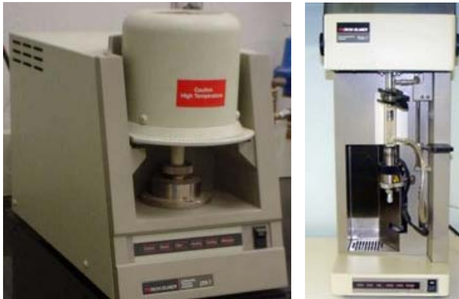
Figura 3.8. Equipos de ATD-TG DTA7 (izquierda) y TGA7 (derecha).
