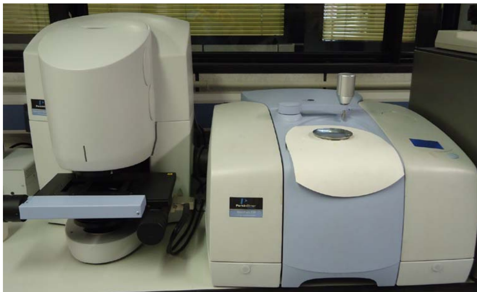
Figura 3.9. Espectrofotómetro FTIR Perkin Elmer Spectrum 100, Microscopio, ATR.
