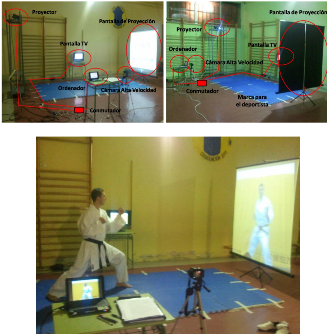
Figura 59.- Esquema del procedimiento de preparación de las instalaciones para la toma de datos
