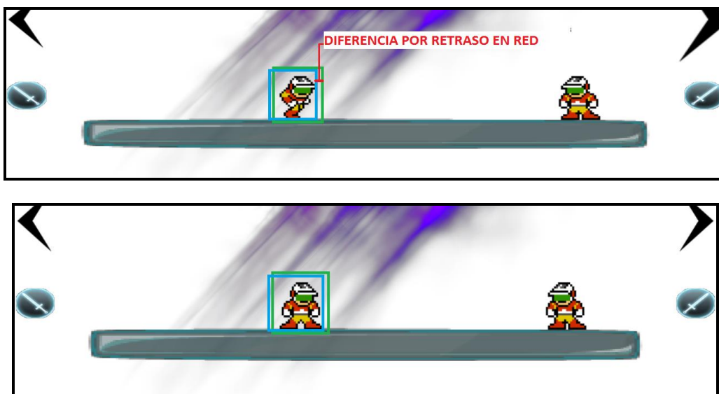
FIGURA 22: CLIENTE Y SERVIDOR COORDINADOS (COLOR VERDE= CLIENTE; COLOR AZUL= SERVIDOR)
