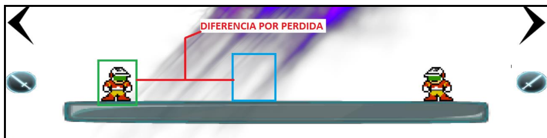
FIGURA 24: CLIENTE Y SERVIDOR DESFASADOS POR PERDIDA EN EL SEGUNDO ENVÍO (COLOR VERDE= CLIENTE; COLOR AZUL= SERVIDOR)
