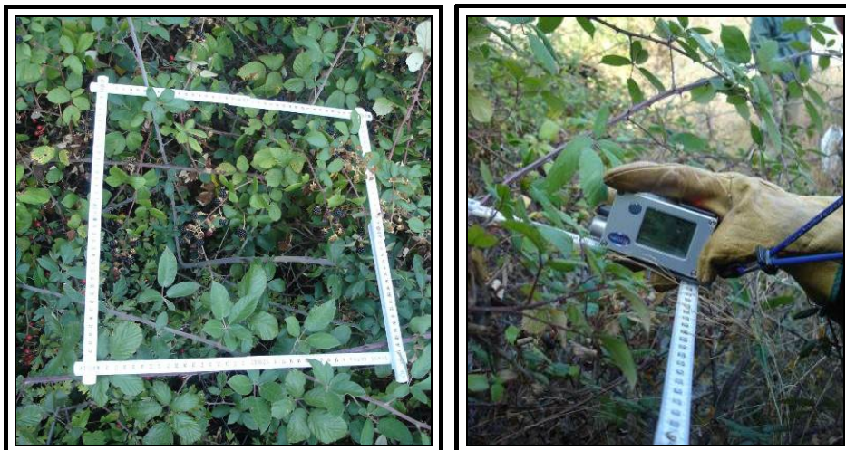
Figura 2.39 Medición del número de frutos por unidad de superficie en Rubus ulmifolius , utilizando como unidad de muestreo un cuadrado de 40 x 40 cm (izda.). Cálculo de la inclinación del cuadrado mediante hipsómetro (dcha.). Fotografías: M. Molina.
