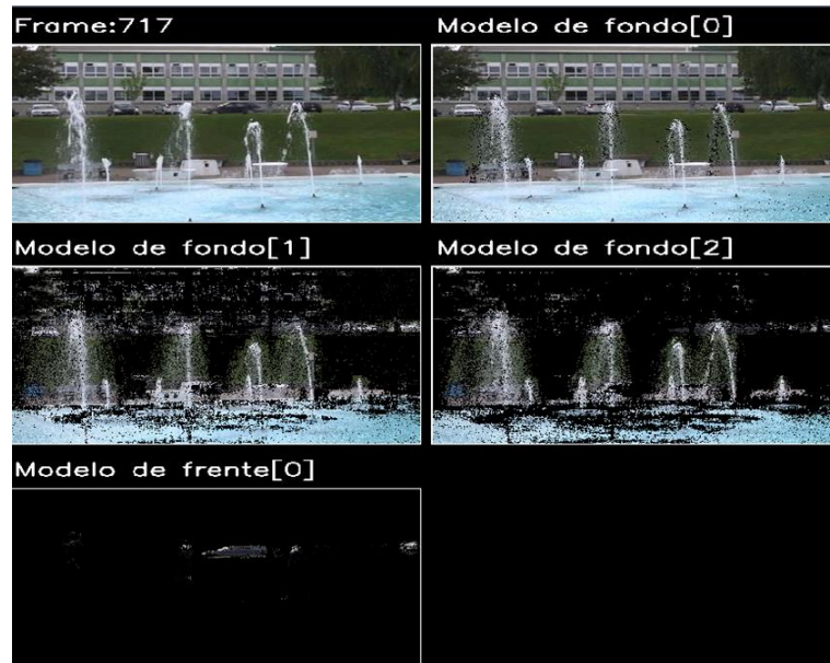
Figura 3.4-1: Representación de modelos de fondo y frente multicapa.
