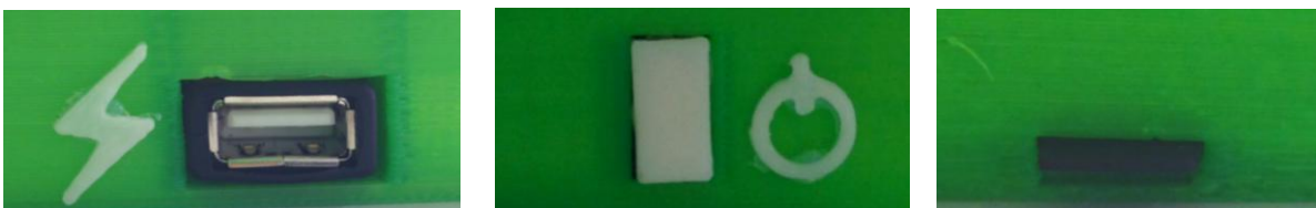
Figura 11: Vista lateral de la caja: Ranura para cargar, botón de Encendido y slot para la tarjeta microSD
