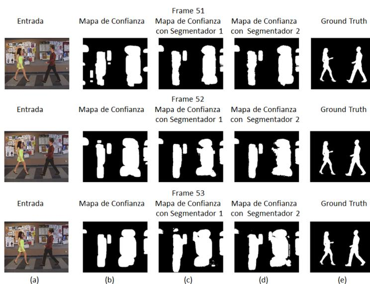
Figura 3.5: Máscaras de Salida de la ejecución de la primera aproximación. Frame entrada (a) Máscara segmentador Persona-Fondo (b) Máscara segmentador 1 Frente-Fondo (c) Máscara segmentador 2 Frente-Fondo (d) *Ground Truth* (e)
