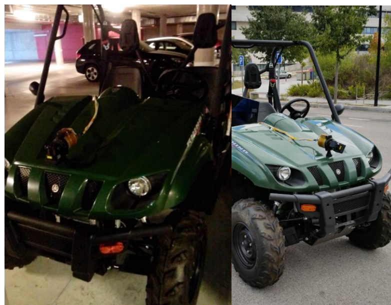
Figura 6-25: Vehículo Yamaha Rhino equipado con el sistema sensorial
