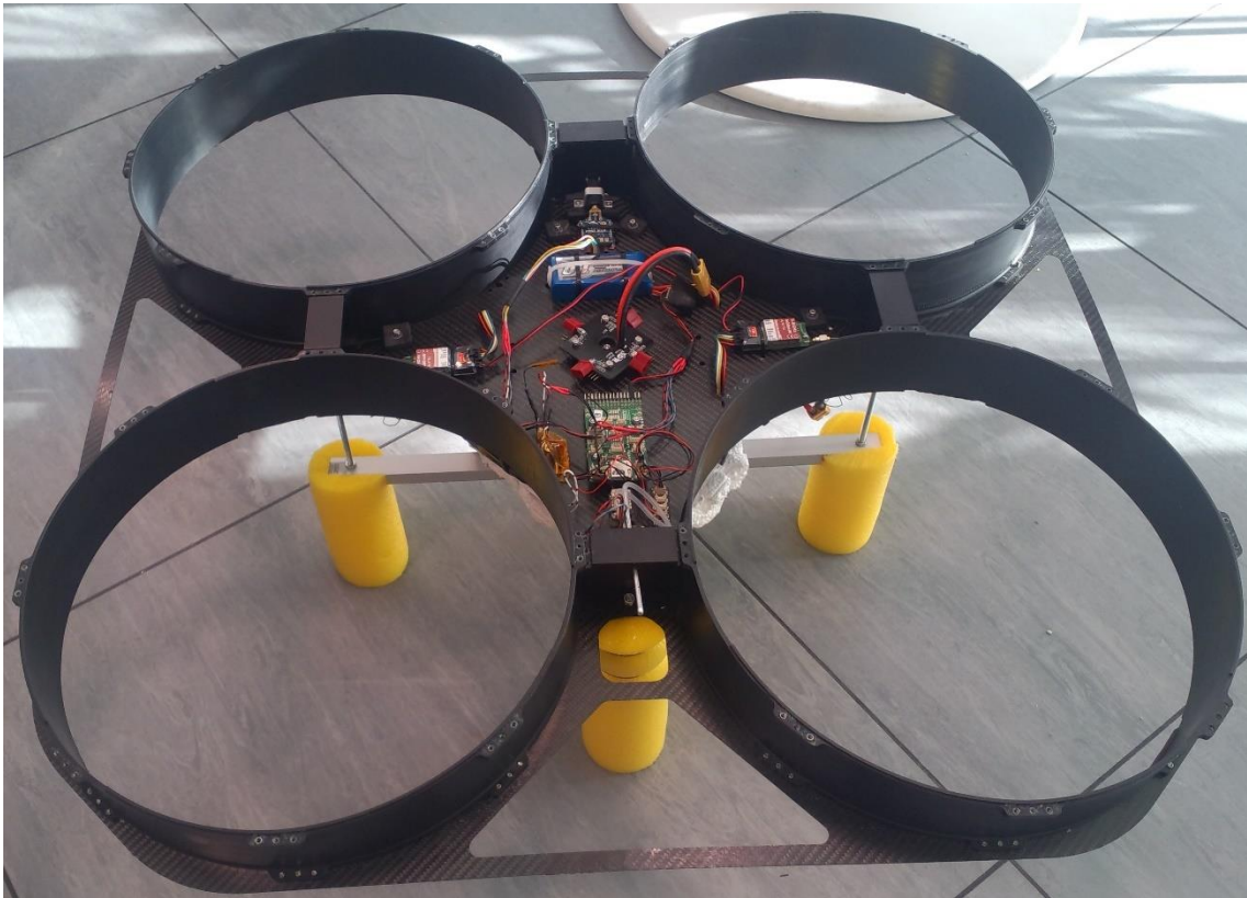
Figura 4-24. Unión de placas inferior y de electrónica
