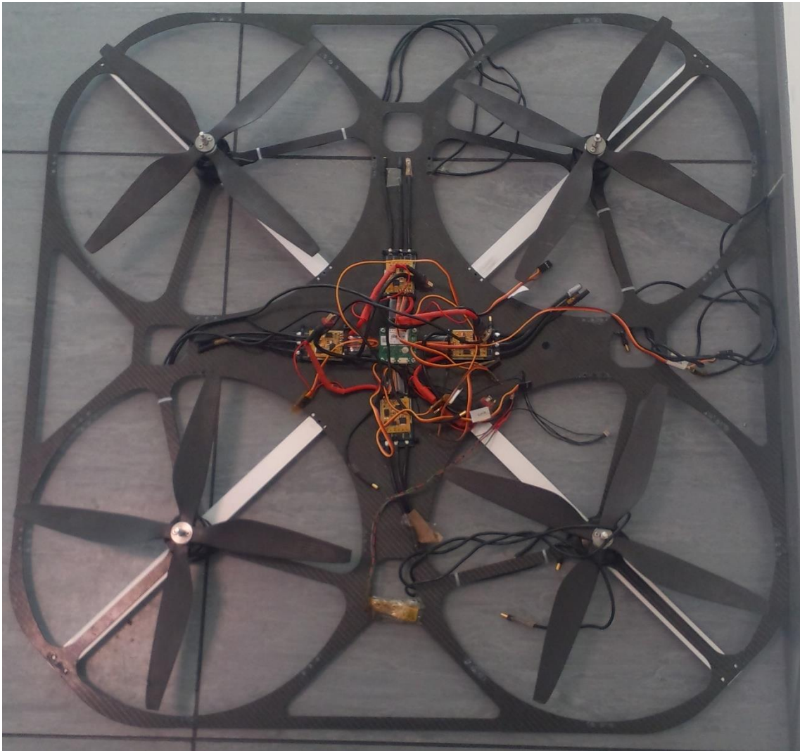
Figura 4-22. Montaje variadores, motores y GPS
