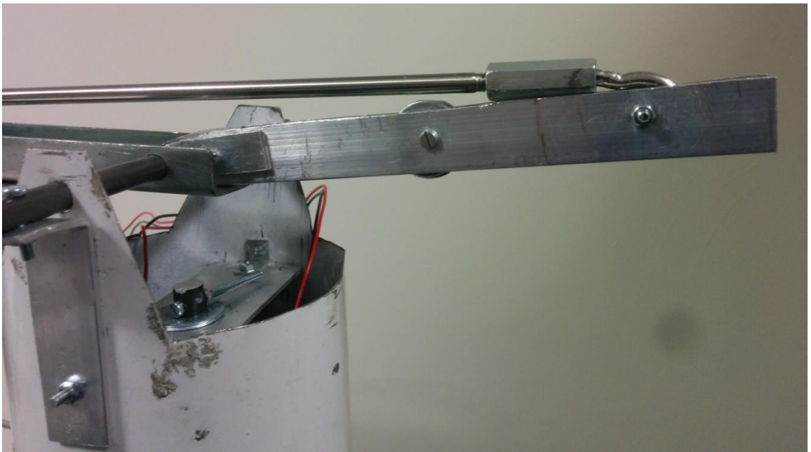
Figura 53: Pieza intermedia de unión entre varilla y eje de rotación
