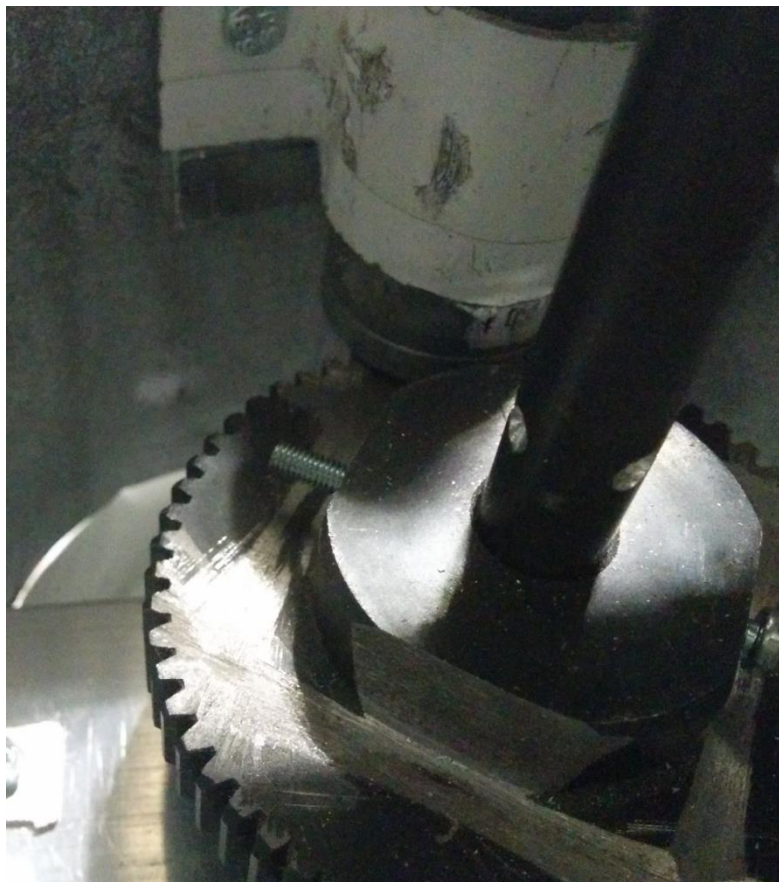
Figura 65: Unión del engranaje a la varilla y acoplamiento con el motor interno
