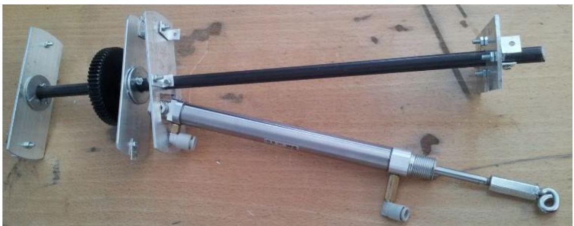
Figura 64: Estructura de varillas para la roación longitudinal del brazo
