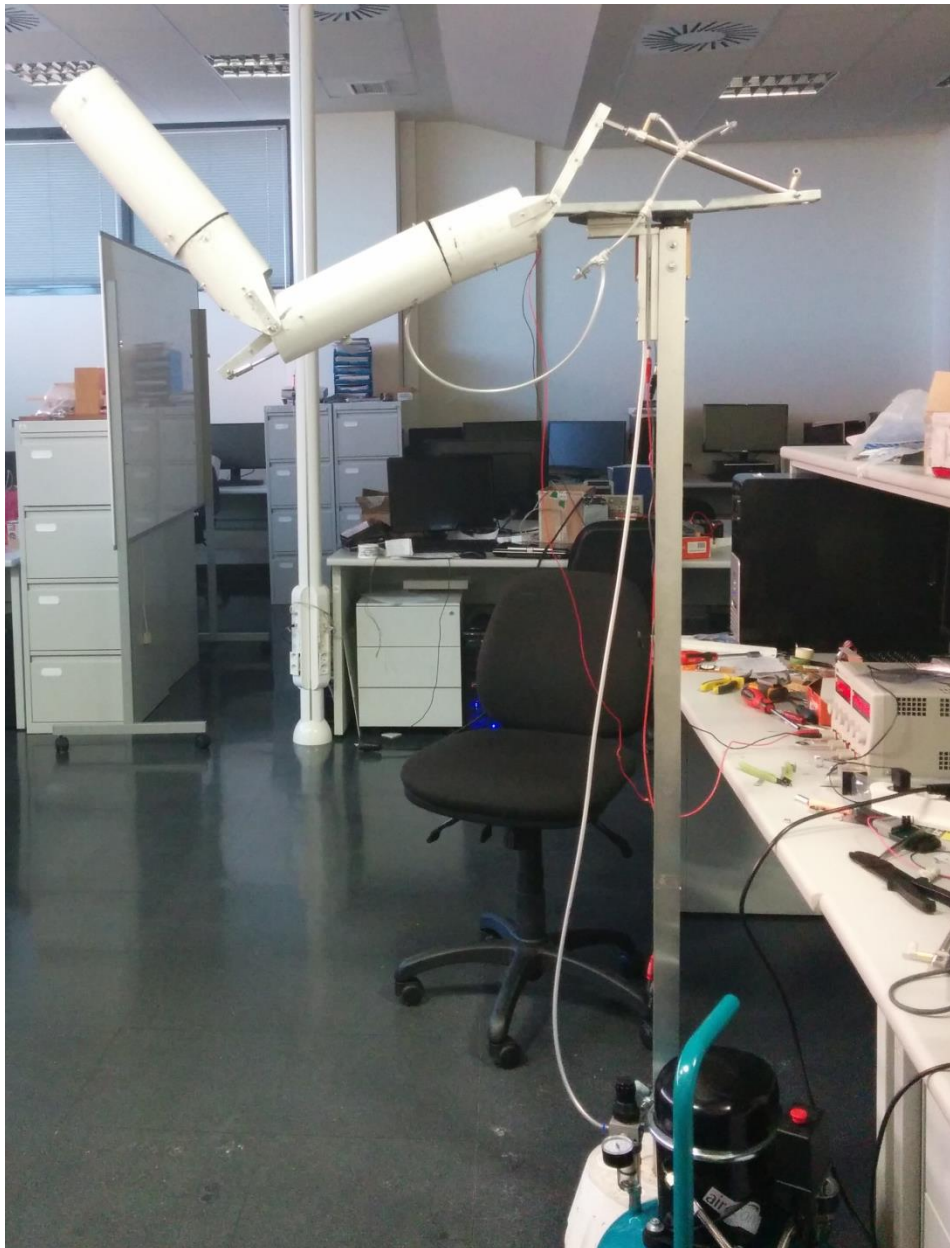
Figura 82: Prueba de los pistones neumáticos
