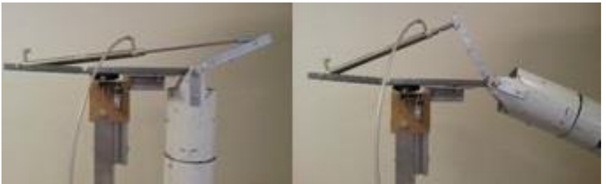
Figura 57: Rango de movimiento de la rotación vertical del hombro.
