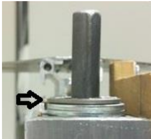
Figura 50: Rodamiento en el eje de rotación horizontal
