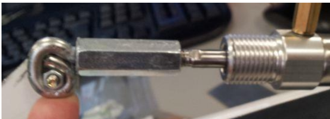
Figura 55: Pieza de unión entre la varilla y la pieza intermedia.
