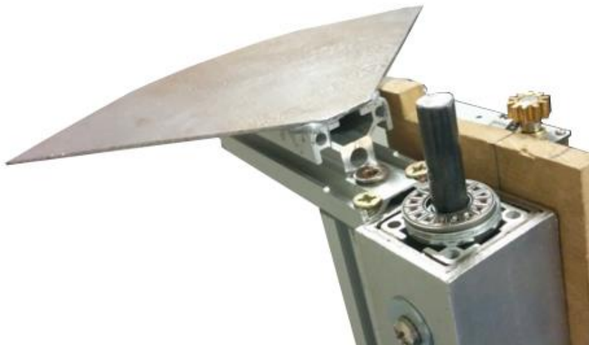
Figura 51: Conjunto de componentes del eje de rotación horizontal
