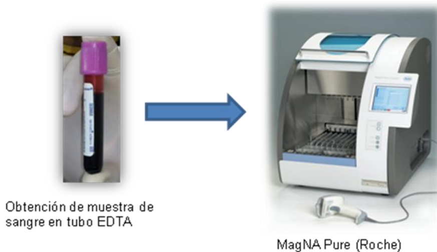
Figura 9. Obtención de muestras de sangre en tubo de EDTA y obtención de DNA mediante un proceso automatizado realizado mediante el extractor de ácidos nucleicos MagNa Pure ® .
