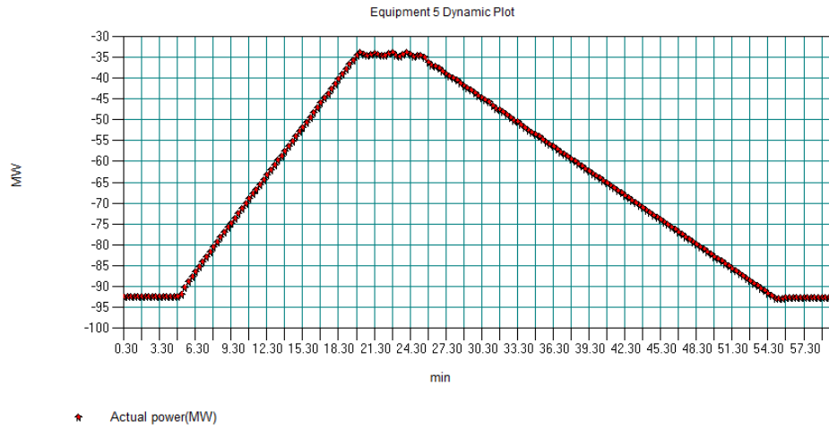
Figura 52: Transitorio en la generación de potencia en la sección de alta presión de la turbina en el caso de estudio 1 para variación de carga (valores negativos).
