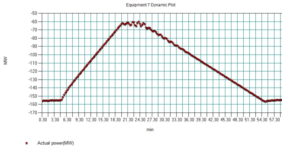
Figura 53: Transitorio en la generación de potencia en la sección de media presión de la turbina en el caso de estudio 1 para variación de carga (valores negativos).
