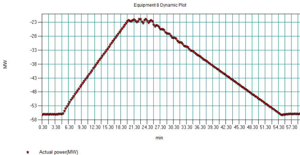
Figura 54: Transitorio en la generación de potencia en la primera sección de baja presión de la turbina en el caso de estudio 1 para variación de carga (valores negativos).
