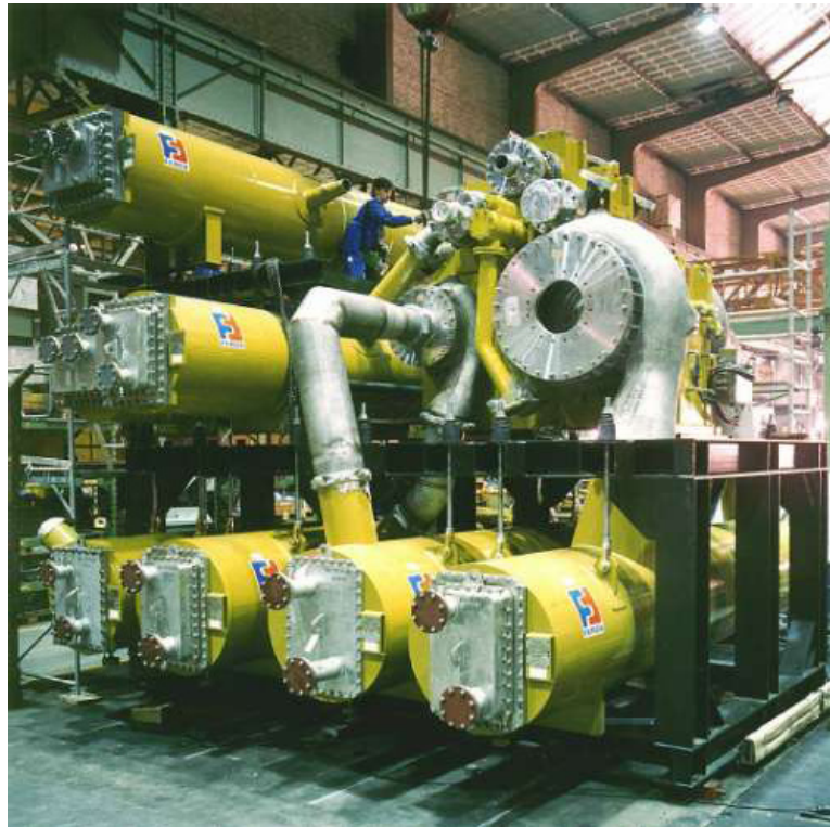
Figura 30: Compresor centrífugo multietapa (integrally geared) con refrigeraciones inter-etapa, utilizado en la industria de proceso de gas. Fuente: MAN Turbo AG [50]
