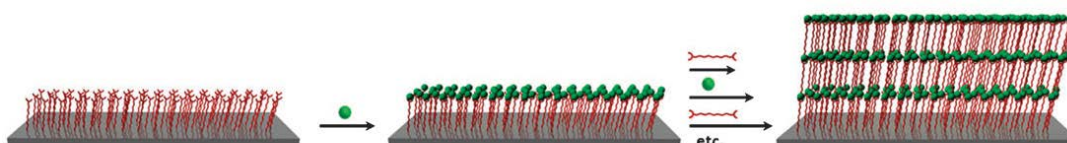
Figura 1.13. Ilustración del crecimiento “paso a paso” de monocapas de moléculas metal-orgánicas 1D y 2D 62b .
