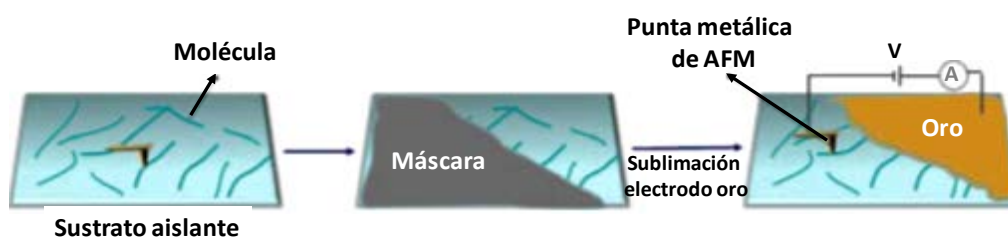
Figura 2.11. Esquema del experimento desarrollado para la medida de corriente eléctrica mediante C-AFM.
