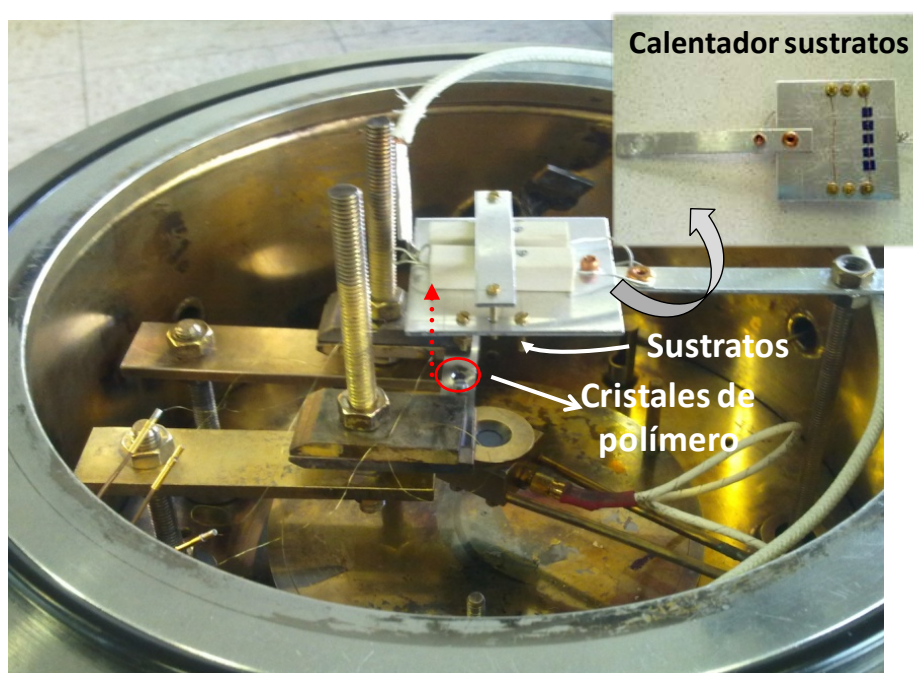
Figura A.2. Fotografía del sistema de vacío utilizado para realizar el experimento de sublimación y detalle insertado del calentador de sustratos con las superficies de \text{SiO}_2 empleadas.
