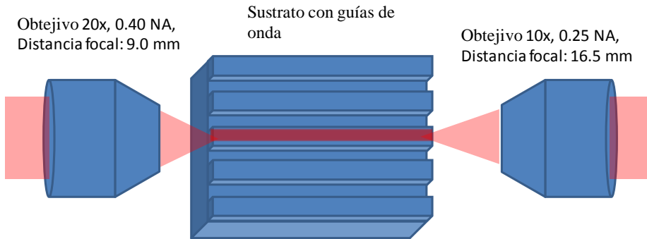
Figura 5.10: Esquema de acoplo de luz mediante objetivos de microscopio.
