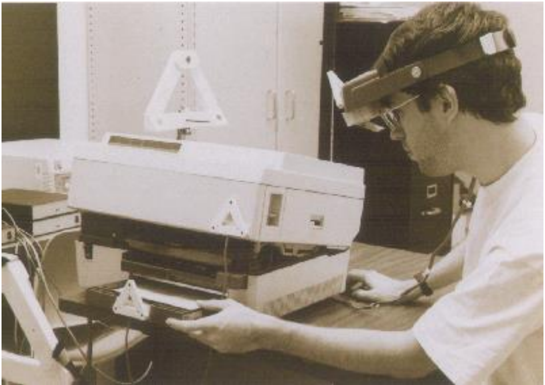
Ilustración 7: KARMA, sistema HMD de Feiner
