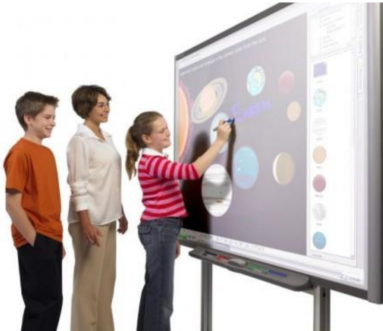
Ilustración 35: PDI resistiva SMART Serie 600
