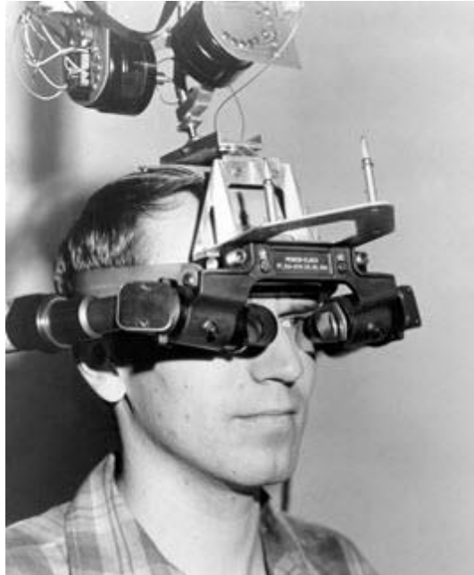
Ilustración 6: Dispositivo en cabeza de Sutherland
