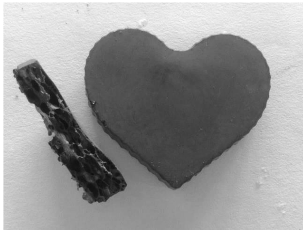
Figura 4.22 Estructura de una muestra obtenida por el método de emulsión
