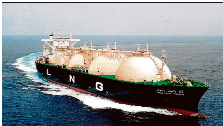
Foto 4.5: Buque Metanero con Estructura de Moss Rosenberg
