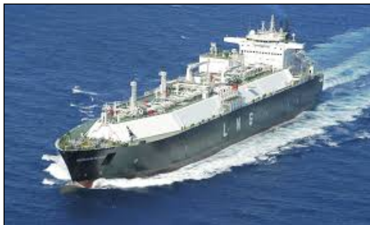
Foto 4.4: Buque Metanero con Estructura de Membrana
