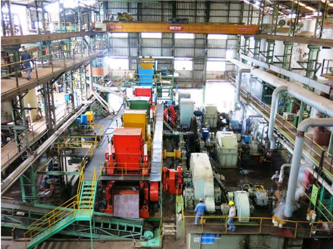
Vista panorámica del Ingenio. Línea de trapiches y distribución de los jugos y el bagazo. [Fotografía de Patricia Gutti]. (Tucumán, 29/05/2015)
