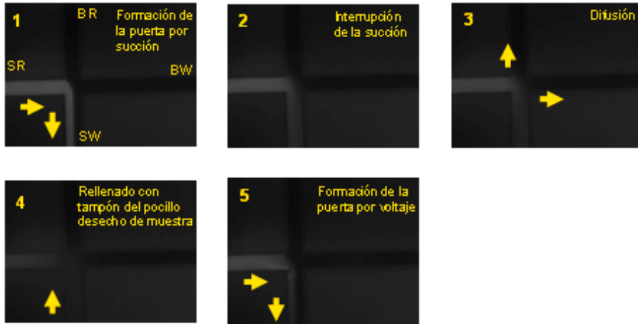
Figura 30. Secuencia de imágenes que recogen la destrucción del stacking formado por succión al desconectar el tornillo por el que se realiza la succión. 1) Formación de la puerta mediante la succión que se lleva a cabo por el pocillo de desecho de muestra. 2) Interrupción de la succión y comienzo de la difusión de muestra. 3) Progreso de la difusión de muestra hacia el resto de canales. 4) Rellenado del pocillo de desecho de muestra con tampón de separación. 5) Formación de la puerta por voltaje.
