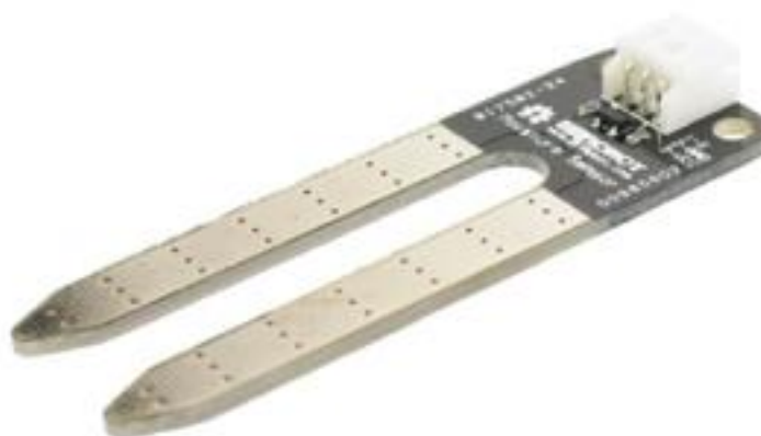
Figura 2-18: Sensor de humedad de tierra SEN0114 [5]
