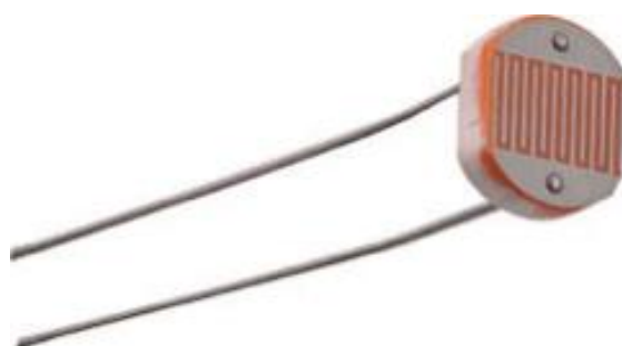
Figura 4-23: Sensor de luz LDR. Fuente [14]
