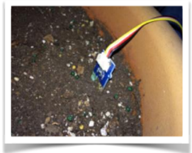
Figura 4-25: Medida de la humedad de tierra.
