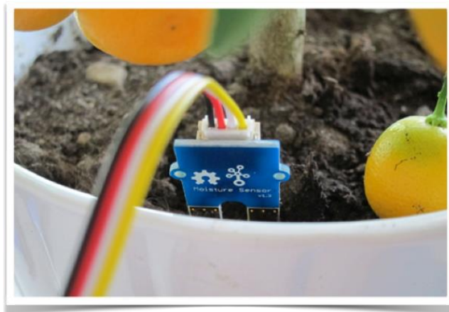
Figura 4-26: Sensor de humedad de tierra
