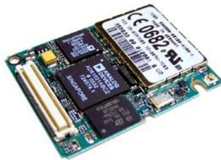
Figura 3.22: Módulo GSM TC65 (Siemens).
