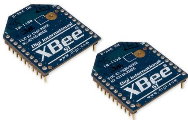
Figura 4.13: Módulos Xbee Series 1 utilizados en el proyecto
