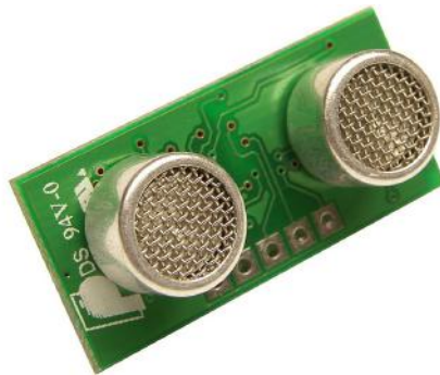
Figura 3.6: Sensor de ultrasonidos modelo SRF10.
