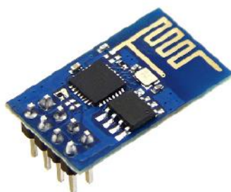
Figura 3.17: Módulo WiFi ESP8266 (Adafruit).
