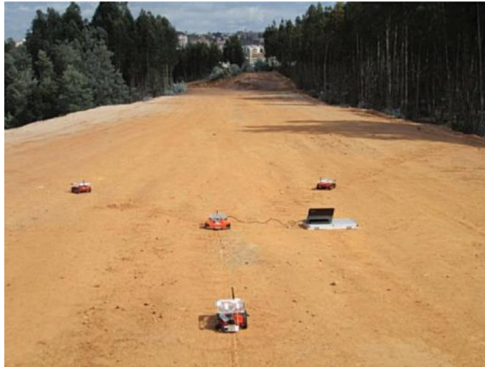
Figura 2.15: Red de robots cooperativos mediante comunicación Zigbee referida al estudio [4].
