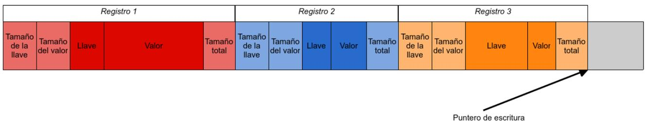
Figura 4: diagrama de la estructura de almacenamiento persistente de pares
