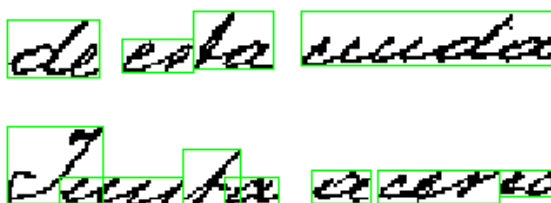
Figura 55: Detección errónea de componentes conectados sobre imagen
