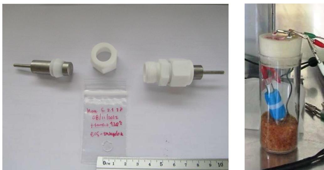
**Figura 3.34.** Celda tipo Swagelok®, muestra de membrana autosoportada y detalle del vaso.
