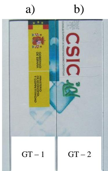
**Figura 5.2.6.** Fotografía de recubrimientos depositados sobre sustratos de vidrio y tratados térmicamente a 150 °C. a) GT – 1, Sin LiAc. b) GT – 2.
