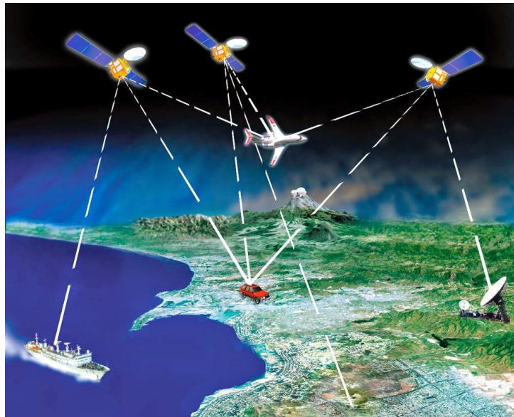
Fig. 1-11: GPS, sistema de localización que mide el tiempo de vuelo (imagen extraída de www.ubuntuleon.com )
