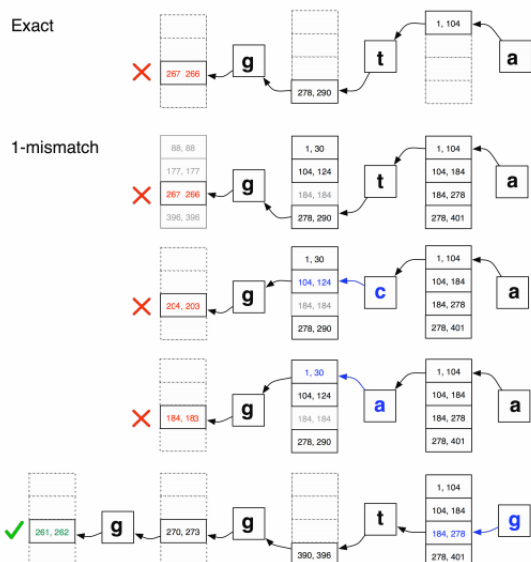
Figura 4.1: Algoritmo de búsqueda inexacta de Bowtie. Cada par de números hace referencia al SA correspondiente. Cuando se produce que sp > ep no hay búsqueda exacta y se realiza backtracking [4].
