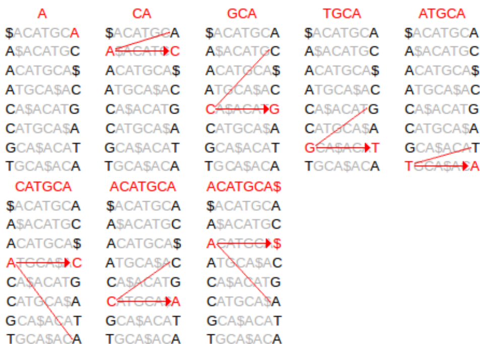
Figura 3.1: Algoritmo UNPERMUTE de la cadena "AC$CGATA"
