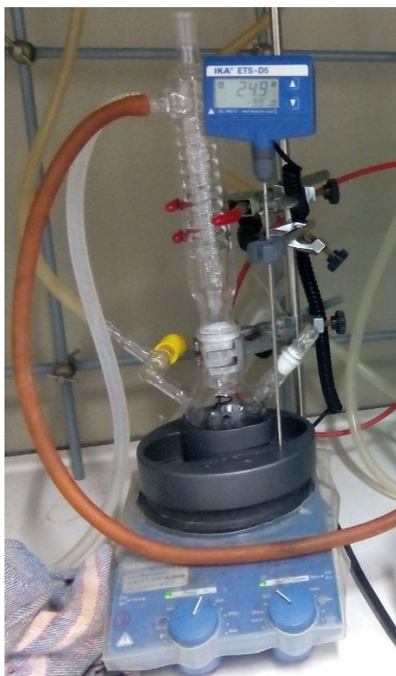
Figura 13. Montaje experimental utilizado para la síntesis de los catalizadores.
