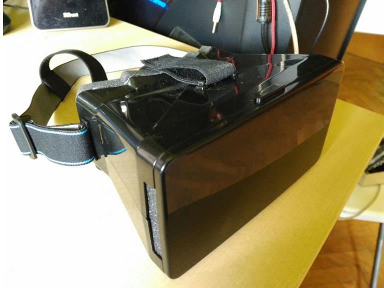
Figura B.5: Gafas de realidad virtual de plástico: estas gafas son más ergonómicas, ya que tiene gomaespuma en las zonas que hacen contacto con la cara y la cinta elástica se ajusta mejor a la cabeza.
