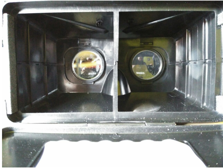
Figura B.7: Gafas de realidad virtual de plástico: las lentes enfocan las imágenes que se muestran en la pantalla del dispositivo móvil, adaptándolas al ojo para que el usuario pueda sentir la profundidad a partir de las dos vistas.
