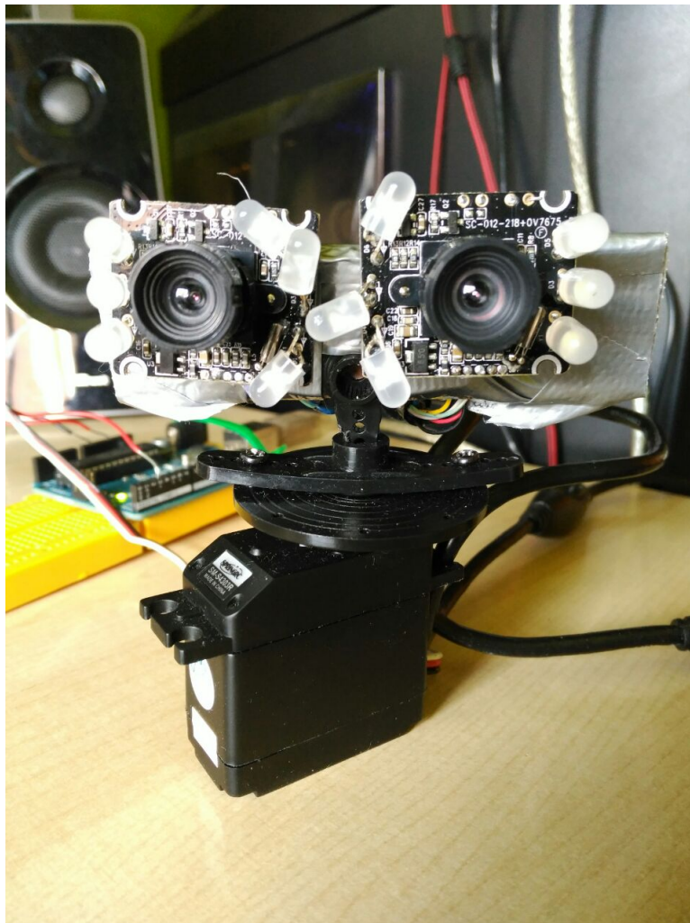
Figura B.3: Videocámaras sobre el servomotor: la estructura con las cámaras se coloca perpendicularmente sobre una estructura circular de un par de pulgadas de diámetro, que a su vez está enganchada al engranaje al cual hace girar el servomotor.
