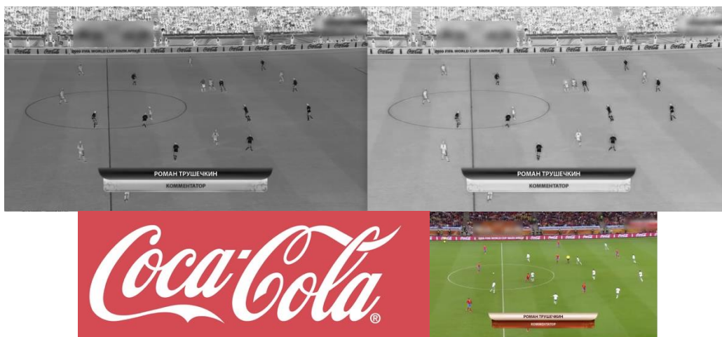
Figura 4-2: Distancias de color a blanco (izda. Delta-E, dcha. Euclídea) para la detección del logo de CocaCola™ en la imagen de abajo.
