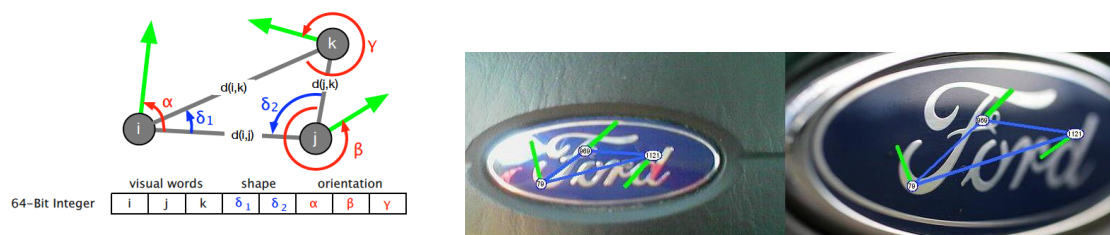
Figura 2-2: Uso de descriptores triangulares con PoIs en el trabajo [4] extraída de la documentación del mismo.
