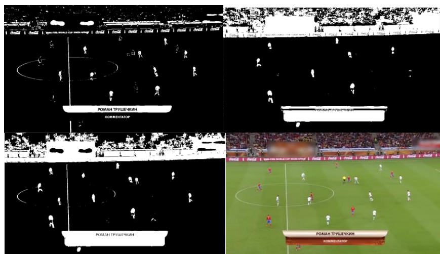
Figura 3-4: Captura del módulo de color. Las imágenes de arriba son regiones con distancias bajas a cada uno de los colores del logo. Abajo se encuentran las regiones adyacentes y la imagen original de referencia.
