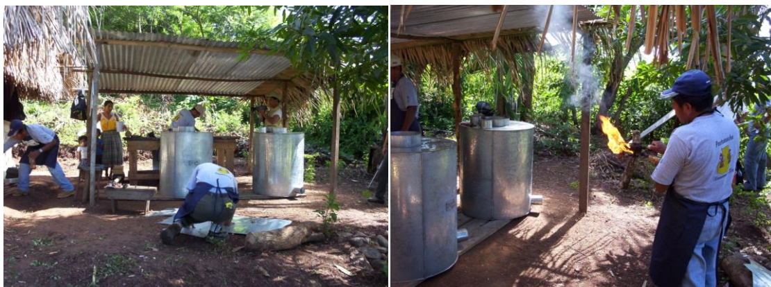
Imagen 27. Proceso de fabricación de silos metálicos
