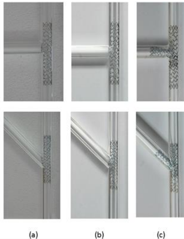
Figura 44. Los modelos experimentales en metacrilato en dos angulaciones de bifurcación, 45° y 90°. a) Stent simple en rama principal. b) Stent en rama principal y apertura del strut hacia rama secundaria mediante kissing balloon . c) Técnica cullotte y kissing balloon final
