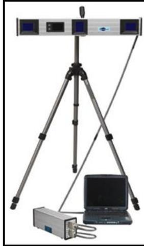
**Figura 7. Unidad sensor del sistema CODA.**
