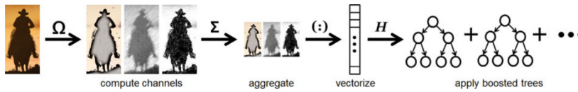
Figura 3.3: Esquema del detector ACF. Procedente de [3].
