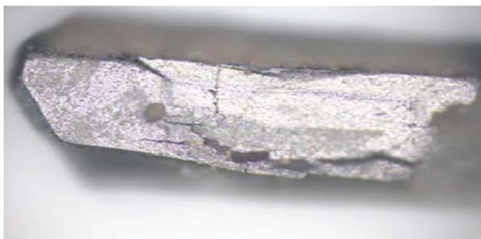
**Figura 45:** Fotografía realizada con microscopio de un cristal del compuesto **4**, mostrando las microfracturas generadas tras ser sometido un ciclo térmico de enfriamiento-calentamiento.
