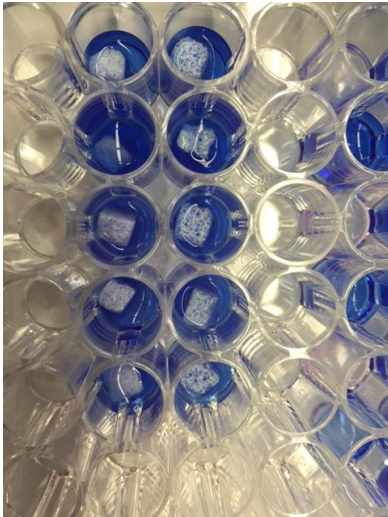
Imagen 20 Placa p48 tras incubación con Alamar Blue, se observan los biomateriales en los pocillos
