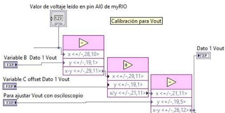
Figura 28: Calibración para Vout en FPGA VI (diagrama de bloques)
