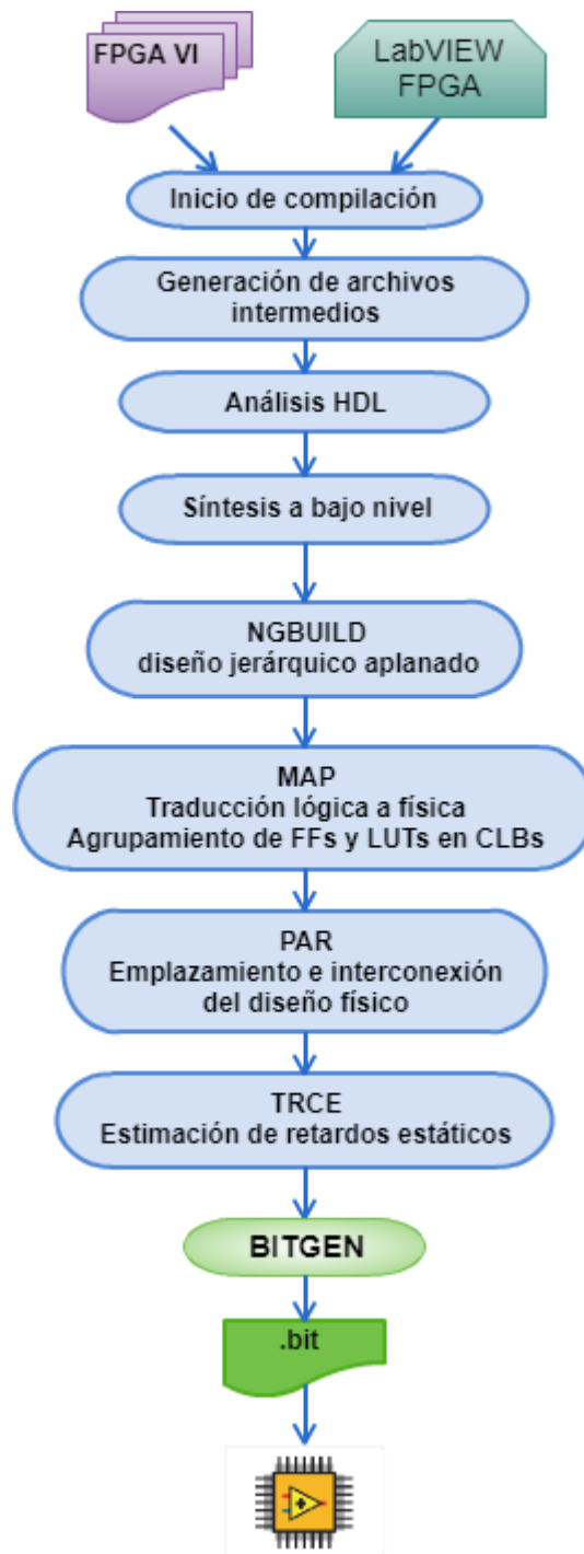
Figura 14: Esquema de generación de archivo bitfile (.bit)
