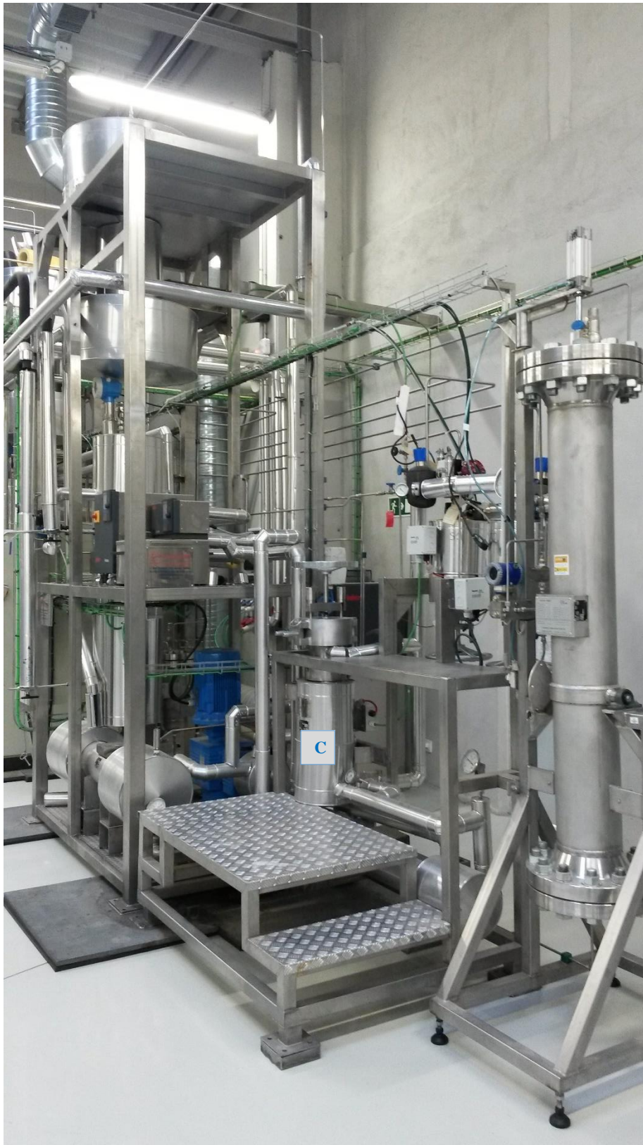
Figura 1.6 Planta de extracción SFE configurada para escalas laboratorio y piloto (ZEAN Engineering, Madrid, España).
