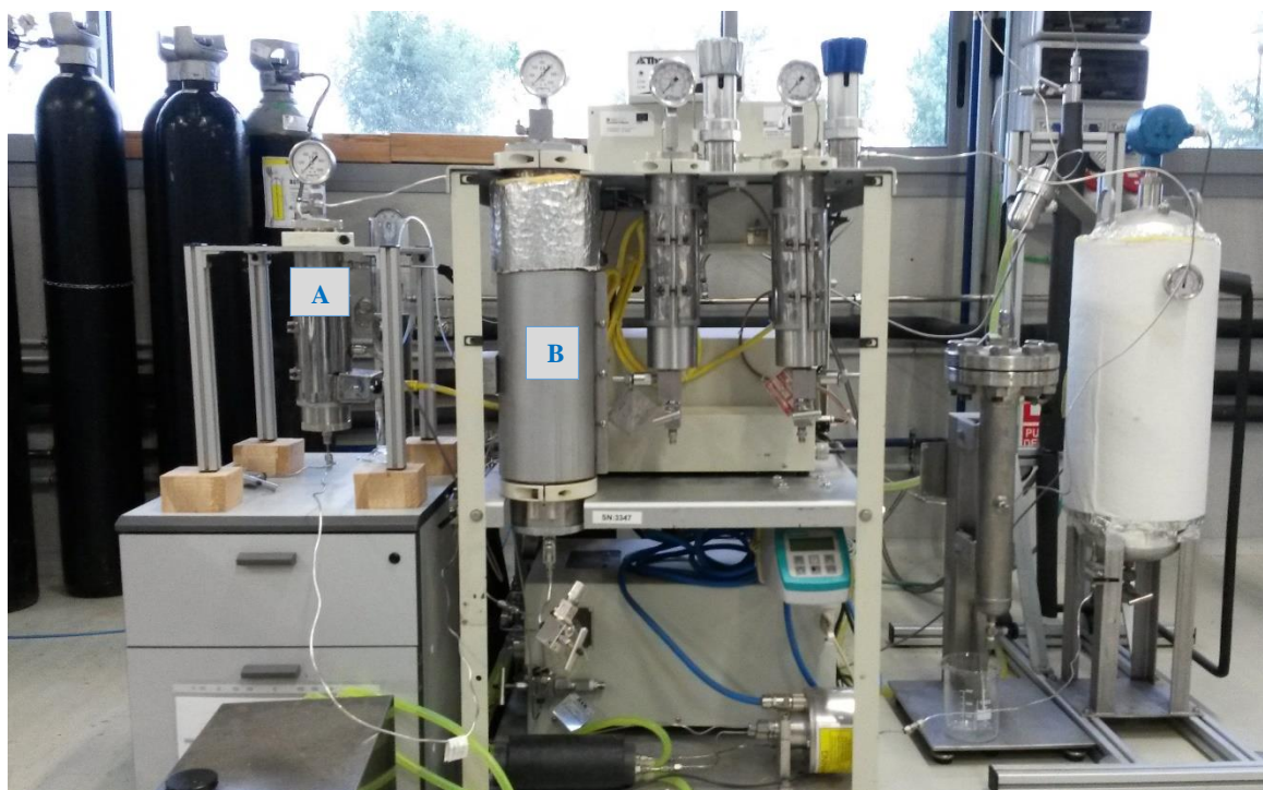
Figura 1.4 Planta de extracción SFE configurada para escalas laboratorio y piloto (Thar SF2000, Thar Technologies, Pittsburgh, Pensilvania, USA).
