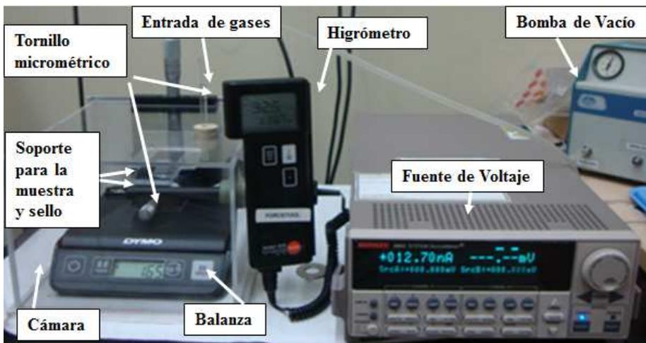
Figura 3.2: Sistema para realizar la nanolitografía de oxidación local en paralelo.
