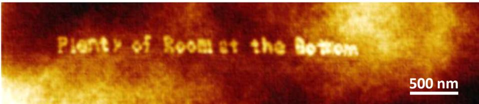
**Figura 1.1:** Imagen de topografía de AFM de una superficie de silicio con un motivo fabricado por o-SPL.
