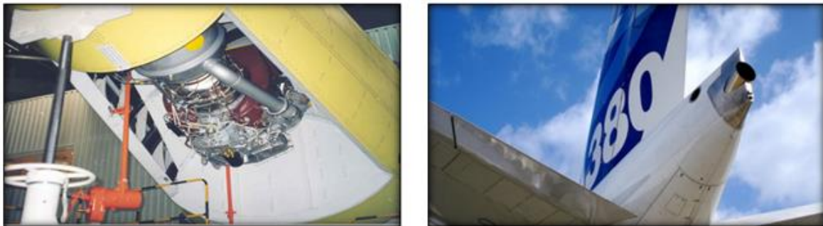
Figura 2-1: En la figura de la izquierda, APU en su fase de instalación para realización de ensayos, en la de la derecha, montado en el avión final
