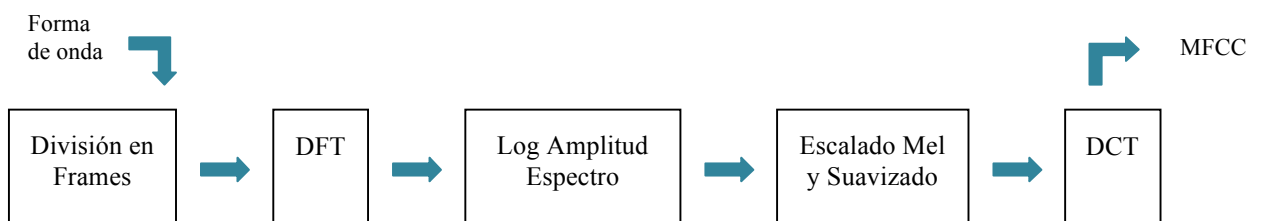
Figura 2-2: Diagrama de bloques del proceso de Extracción de Características
