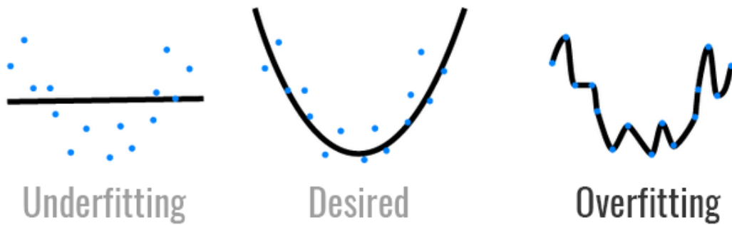
Figura 8. Overfitting, underfitting y situación deseada para las predicciones de un sistema
