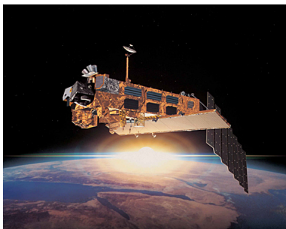
Figura 4.8: Satélite ENVISAT en el que se aloja el espectrómetro SCIAMACHY
