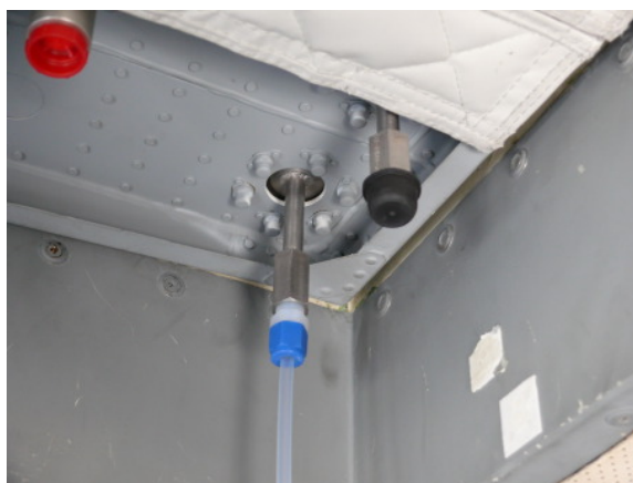
Figura 4.6: Conexión de la toma de muestras del monitor de ozono 2B al exterior
