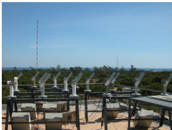
Figura 4.11: Fotómetros CIMEL durante una intercomparación en la sede del INTA (El Arenosillo)
