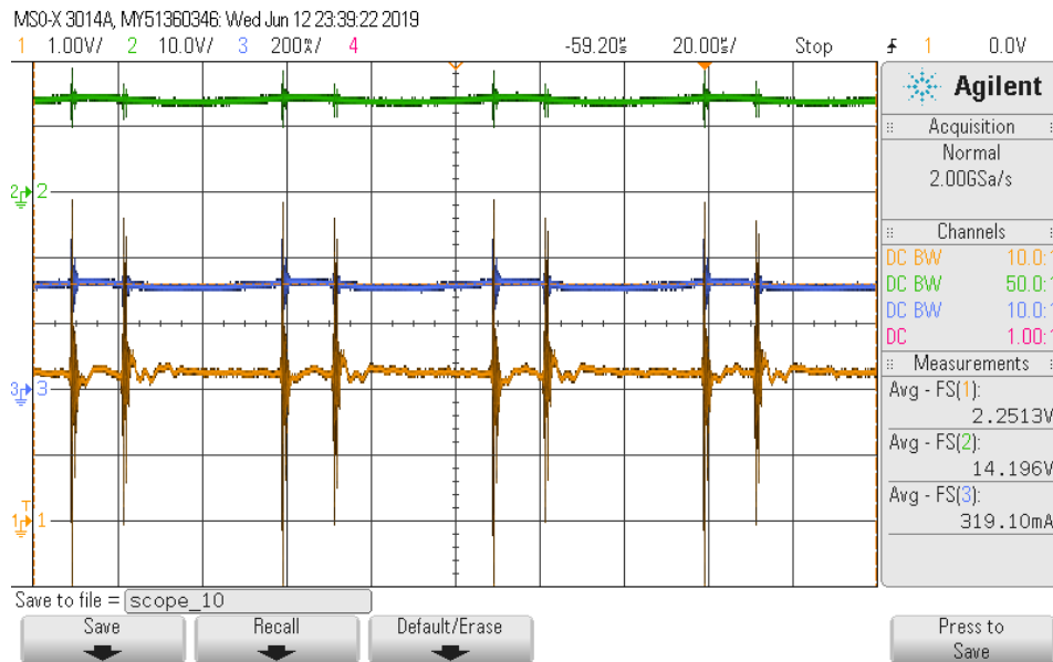
Figura 34: captura de osciloscopio del sensado de corriente ( V_{IN}=30 \text{ V} y D=0,75 )
