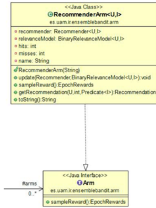
Figura A.2: Diagrama de clases del subsistema arm
