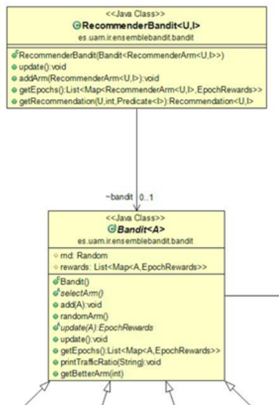
Figura A.1: Diagrama de clases del subsistema recommender
