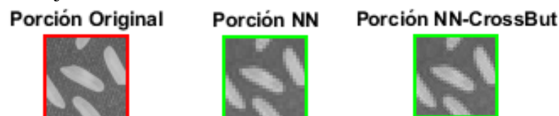
Figura 3-5: Interpolación Nearest-Neighbor con corrección Cross-Butterworth
