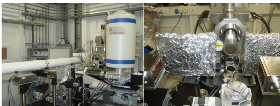
Figura 2.15. Montaje experimental XAS de la línea Spline en el ESRF utilizable tanto en modo fluorescencia como en transmisión.
