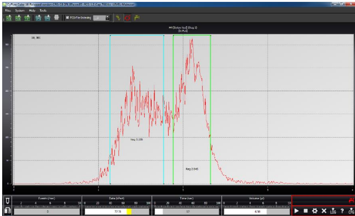
Figura S2: Panel del canal 5, representa la señal de la sonda SYTOX™ Red Dead Cell Stain (abscisas), frente al número de partículas con dicha intensidad (ordenadas). Genera las subregiones 1 (vivos, color celeste) y 2 (muertos, color verde).
