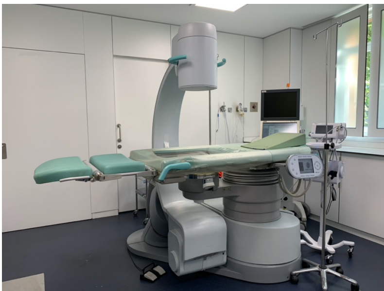
Imagen XVII. Litotriptor Modulith SLX-F2 de Storz Medical. Imagen propia de la Unidad de Litiasis-LEOC y Endourología del Servicio de Urología. HUFJD
