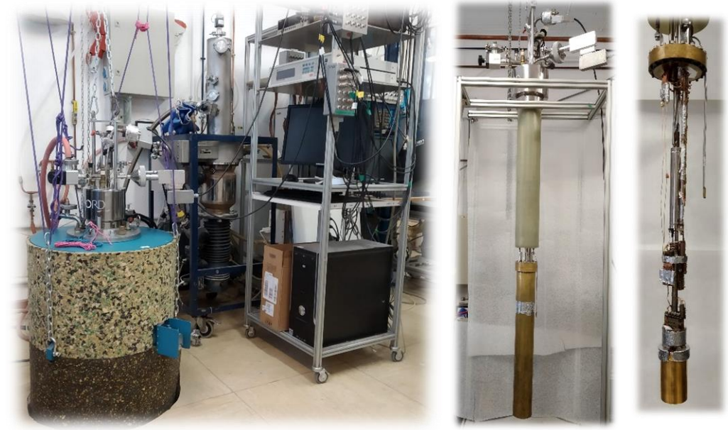
Figura III-5. Esquematación y fotografías del equipo experimental de ^3\text{He} . La pantalla de radiación debe permitir hacer el vacío en su interior a través de algún hueco. Para evitar el paso de radiación a través de este hueco, éste se bloquea con una pantalla "flotante" auxiliar que no cierra físicamente la abertura pero bloquea la radiación del bote de latón.
