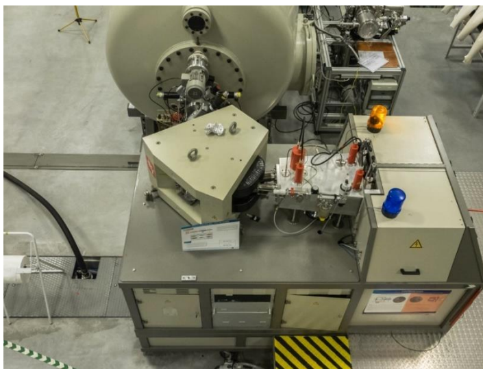
Fig. 1: Zona de las fuentes de iones, inyector e imán de baja energía
