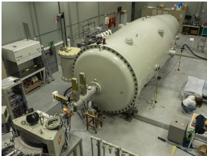
Fig. 2: Acelerador tándem de 5 MV del CMAM junto al imán conmutador.
